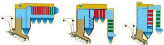
Přehled různých kotelních systémů: horizontální, kombinovaný a vertikální
