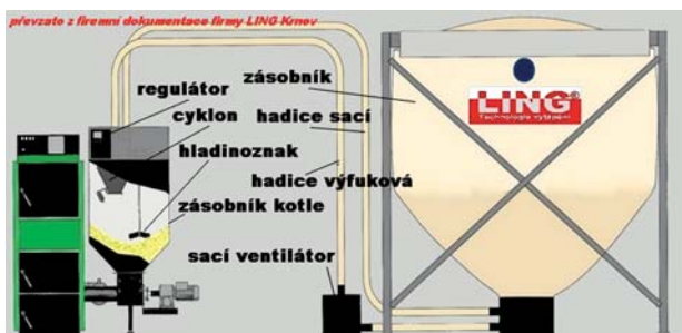
Obr. 6: Schéma pneumatického dopravníku pelet textilní zásobník - kotel
