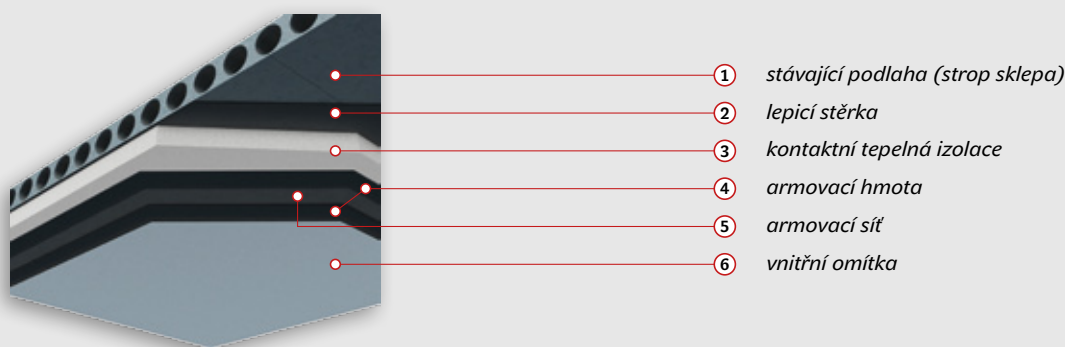
Obrázek 23 | Schéma tepelné izolace podlahy obytné části domu zateplením stropu sklepa
