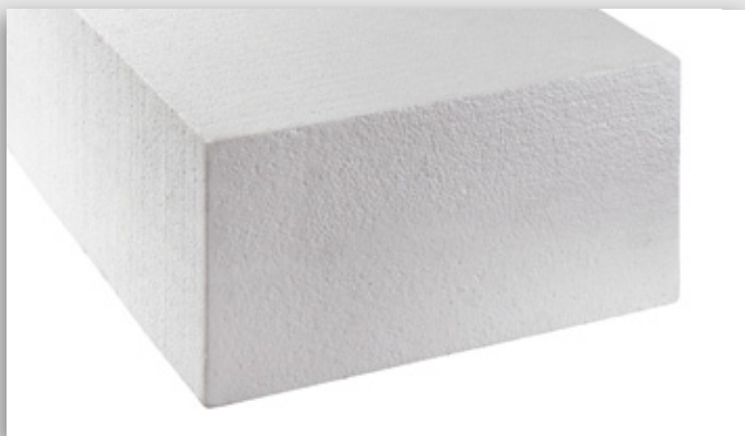
Obrázek 10 | Tuhé desky z pěnového polystyrenu. Zdroj: ENVIC, o.s.
