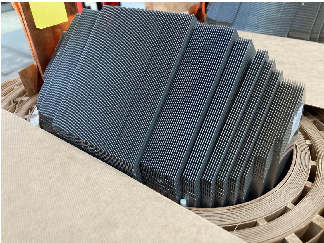
Obrázek 8: Detail sloupku jádra před složením horní spojky
